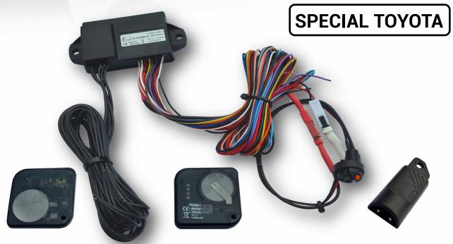
L'anti-démarrage LASERLINE à transpondeur apporte une sécurité supplémentaire à votre véhicule en activant automatiquement une double coupure moteur.
