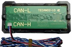
Le module TECAN02 permet de lire le CAN BUS sans faire de connexion électrique sur les fils de multiplexage du véhicule.
